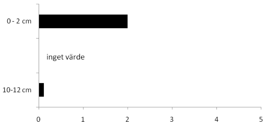
Figur 5 B. Den sammanlagda halten av de 16 vanligaste polyaromatiska föreningarna (PAH) i sediment från olika djup på en station 15 m utanför en slip i en marina i inre del av Stockholm visas i figuren.
